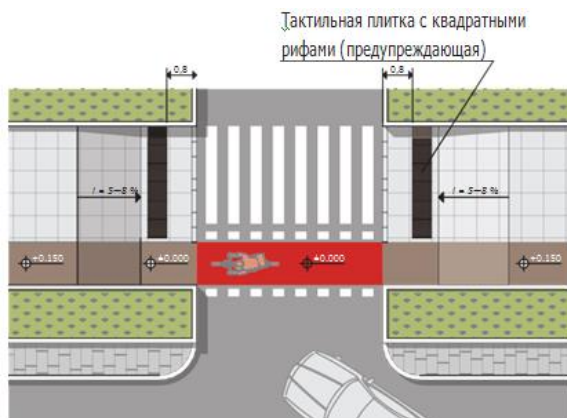
Схема 2. Размещение тактильных указателей при пересечении основных пешеходных коммуникаций с проездами
